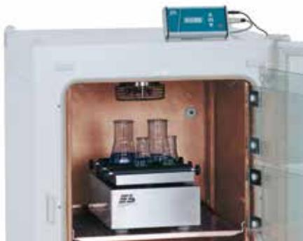
Die externe Steuereinheit mit LED-Anzeige ermöglicht eine komfortable und einfache Bedienung außerhalb des Inkubators. Kabeldurchführung im Inkubator notwendig.
