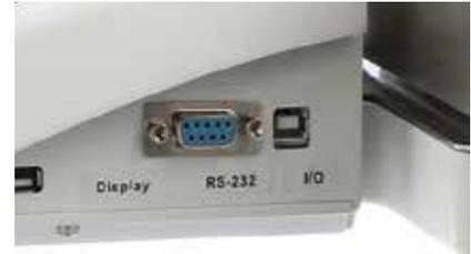
Les interfaces USB et RS-232 permettent une communication rapide avec les ordinateurs et les imprimantes
