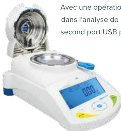
Avec une opération simple et un temps de réponse rapide, le PMB offre une valeur supérieure dans l'analyse de l'humidité. Les interfaces USB et RS232 facilitent la connectivité, alors qu'un second port USB permet de stocker des programmes de test et des données sur des clé USB.
